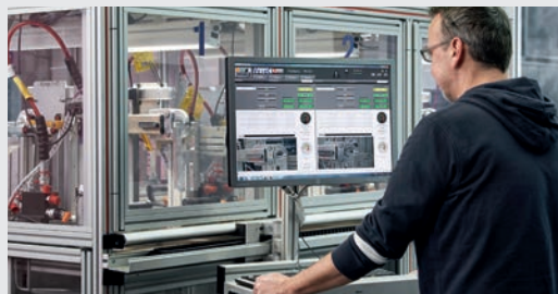
VETEC Prüfstand mit Videoüberwachung VETEC test bench with video monitoring
