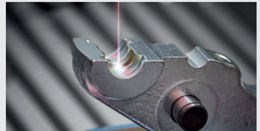
Laserbearbeitung für den Feinschliff Laser processing for fine grinding
